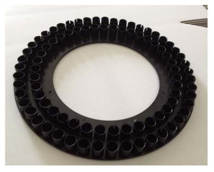
TEST TUBE SAMPLE PLATE
